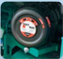
Filtro de aire con doble elemento (Opcional)
